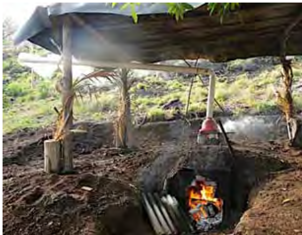
Imagen del horno subterráneo, abierto para ilustración
